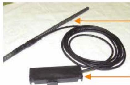
RFIDひずみセンサ
