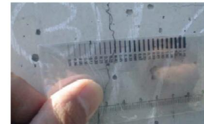
目視点検（ひび割れ幅の計測）
