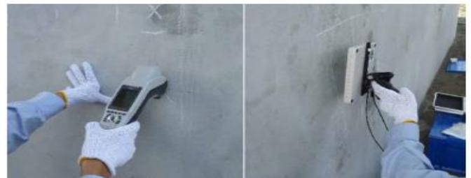
埋設したRFID 腐食環境センサの計測状況
