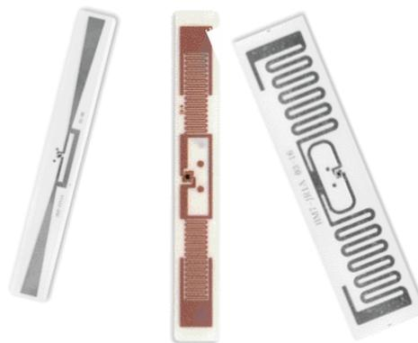
**920MHz帯RFIDシステム例**
