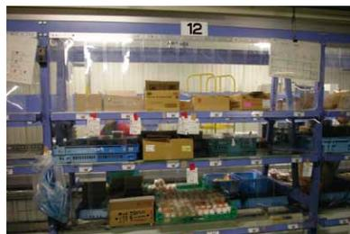
入荷後にロット仕分けがなされた商品は、まず補充室に運ばれる。補充室に運ばれた商品は、あらかじめ決められたロケーションに基づき、集品棚へ補充される。この時、ハンディーターミナルでアイテムを確認し、ロット情報をRFIDに書き込む作業を行う
