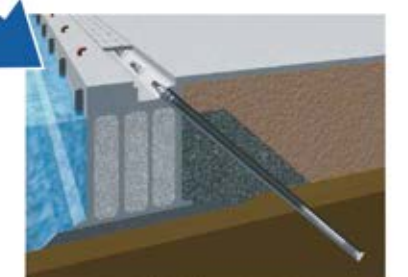
港湾 構造物の耐震補強
