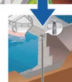
漁港 構造物の耐震補強
