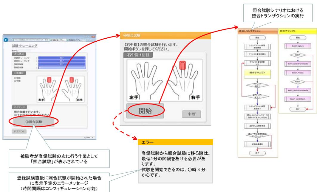
図 5.3-21 バイオメトリック照合試験の画面及び手順例
