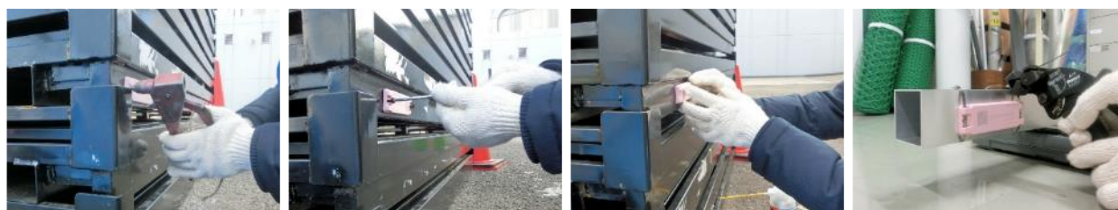
（図 3-11） RF タグ取付作業（左からリベット留め、ボルト留め、両面テープ、結束バンド）
