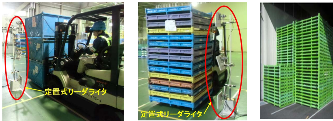
RFIDによる金属製RTIの読取り
