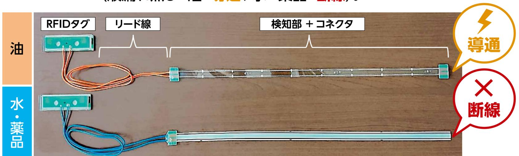
液漏れ検知時 検知部の導通状態がそれぞれの原理で変化します。
