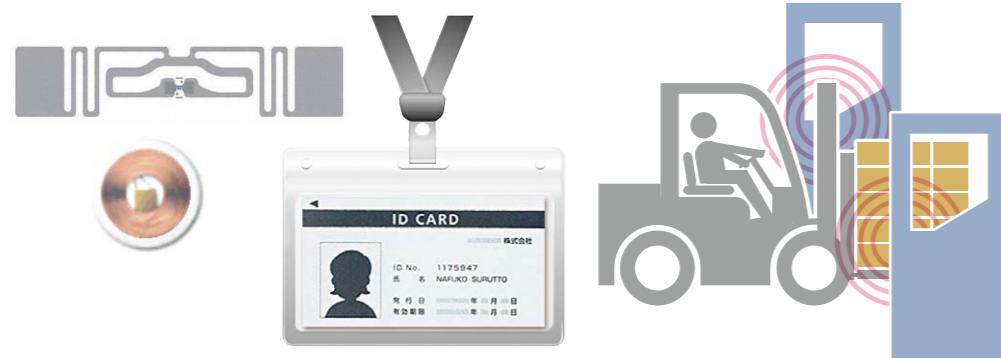
RFID (Radio Frequency Identification) は、電波でICチップに入力された情報を読み取る技術で、データの書き換えができ、複数の物品を同時に読み取ることができます。
