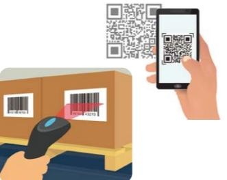
一次元シンボルは、太さの異なるバーとスペースの組合せで数字や文字を表現し、バーコードスキャナ（光学認識装置）で読み取ります。一方で、二方向に情報を持つ一次元シンボルに比べ、二次元シンボルは、縦・横二方向に情報を持つため、より多くの情報を記録できます。
