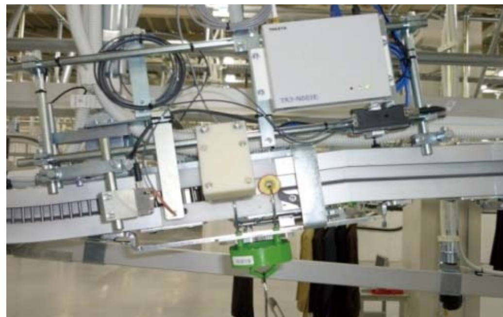
RFID 読取ステーション
