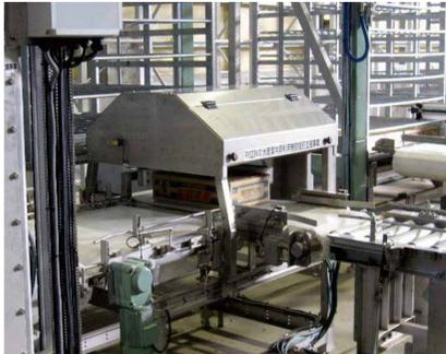
C. 段ボールの魚別バーコードラベルを読取る
