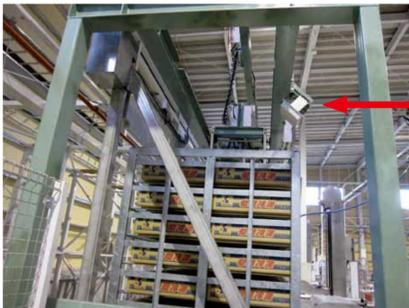
D. RFIDアンテナでコンテナ装着のRFIDに段ボールの魚の種別情報書き込み自動でコンテナに積込む
