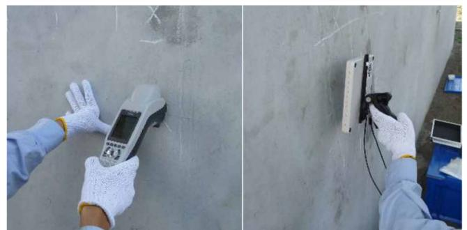
埋設した RFID 腐食環境センサの計測状況
