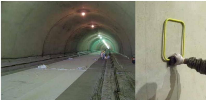
RFID ひずみセンサを設置したトンネルと計測状況
