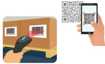
一次元シンボルは、太さの異なるバーとスペースの組合せで数字や文字を表現し、バーコードスキャナ(光学認識装置)で読み取ります。一方方向だけに情報を持つ一次元シンボルに比べ、二次元シンボルは、縦・横二方向に情報を持つため、より多くの情報を記録できます。
