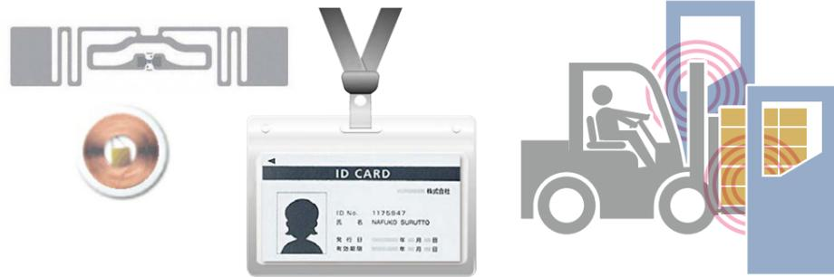
RFID(Radio Frequency IDentification)は、電波でICチップに入力された情報を読み取る技術で、データの書き換えができ、複数の物品を同時に読み取ることができます。
