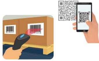
一次元シンボルは、太さの異なるバーとスペースの組合せで数字や文字を表現し、バーコードスキャナ(光学認識装置)で読み取ります。一方向だけに情報を持つ一次元シンボルに比べ、二次元シンボルは、縦・横二方向に情報を持つため、より多くの情報を記録できます。
